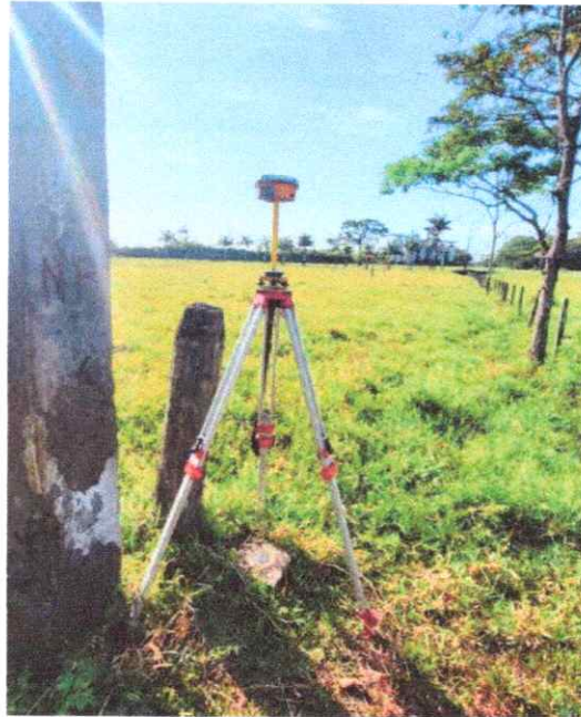
Fotografía 4 Lectura con GPS Hi Target mojon IGAC A26-SE-1
