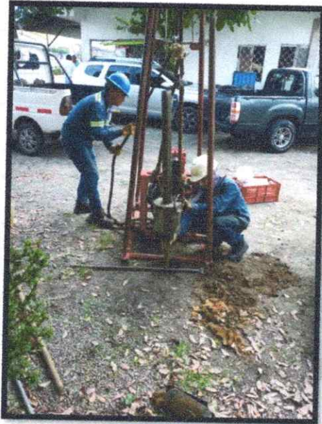
ENSAYO SPT Y RECUPERACION DE MUESTRS ALTERADAS OPTENIDAS MEDIANTE SPLIT SPOOM
