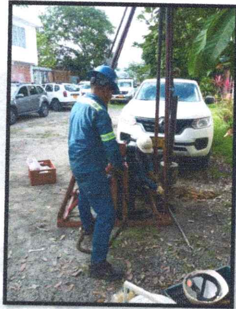
ENSAYO SPT Y RECUPERACION DE MUESTRS ALTERADAS OPTENIDAS MEDIANTE SPLIT SPOOM
