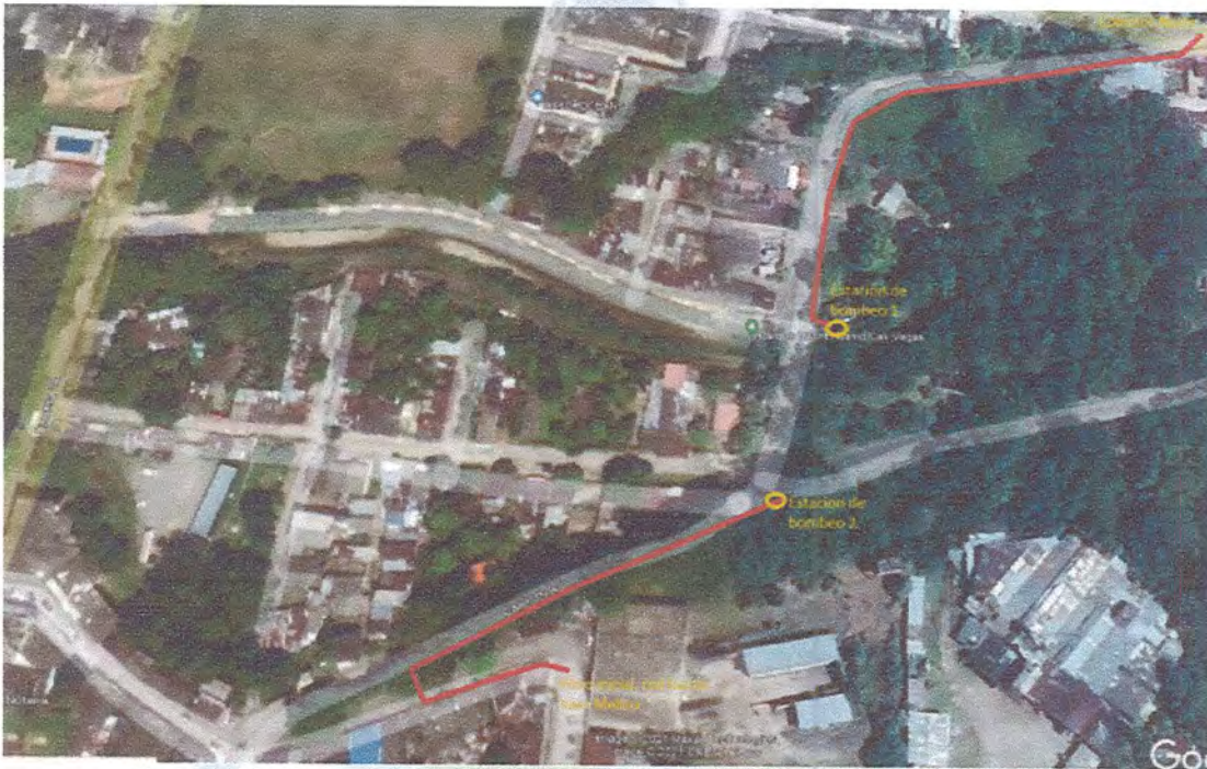
Ilustración 1. Implantación alternativa con doble estación de bombeo
