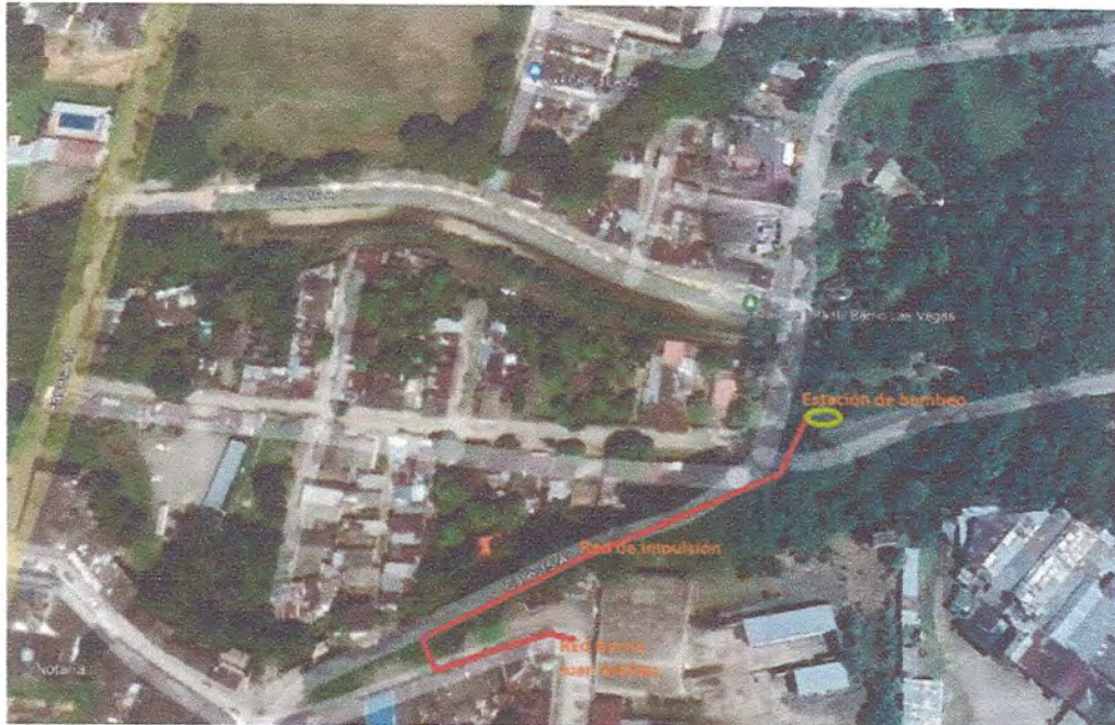
Ilustración 2, Implantación alternativa de una estación de bombeo con conexión al barrio Juan Mellao
