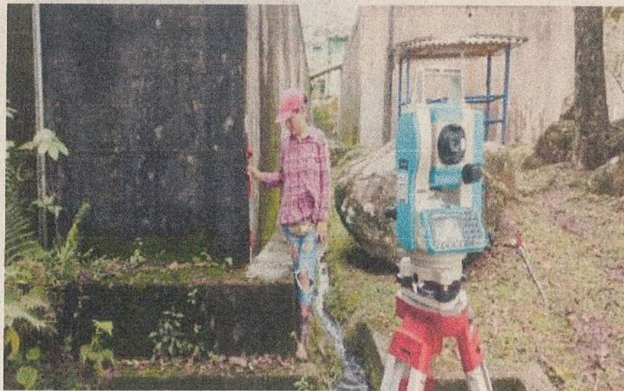
Figura 8 Levantamiento topográfico toma de punto tanque
