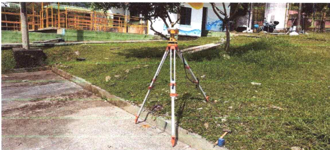
Fotografía 7 Lectura con GPS Hi target GPS-01
