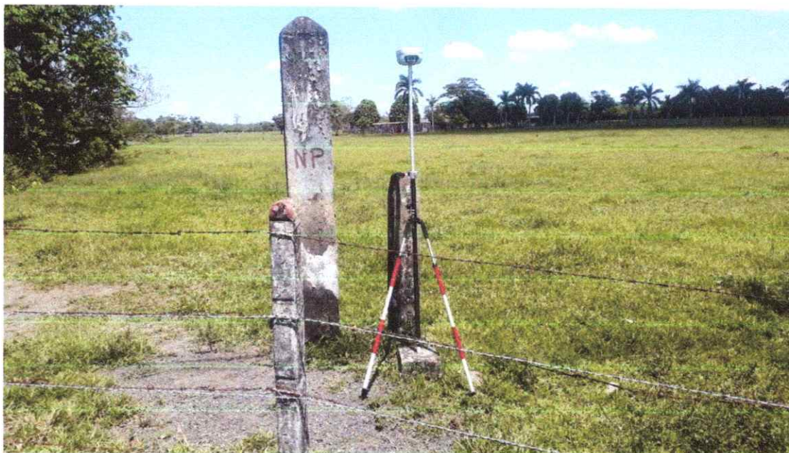
Fotografía 6 Lectura con GPS Hi Target mojon IGAC A26-SE-1
