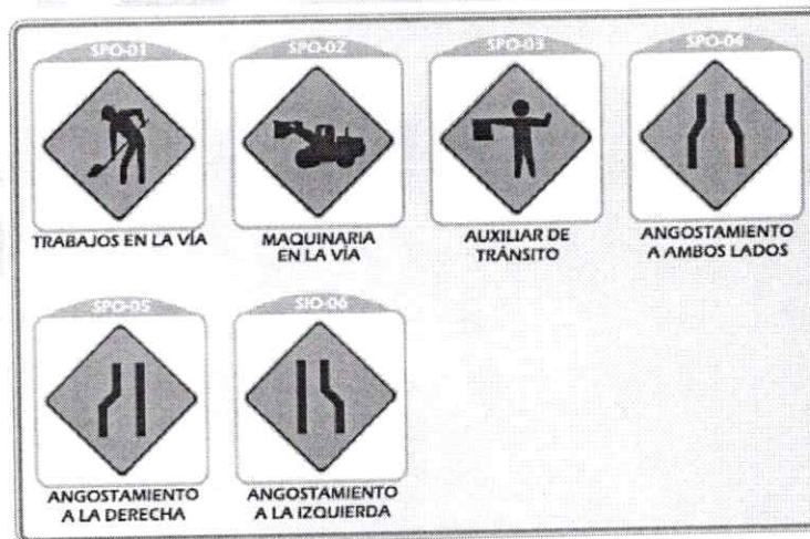
Imagen 3. Señales de Prevención para Zonas de Obras
