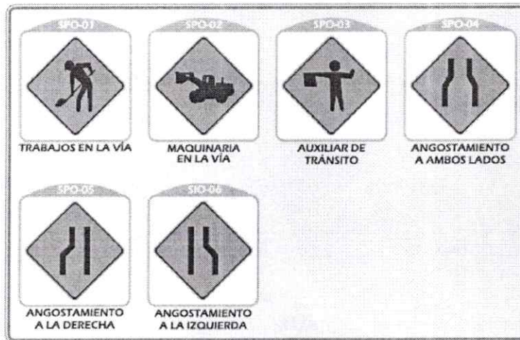
Imagen 3. Señales de Prevención para Zonas de Obras
